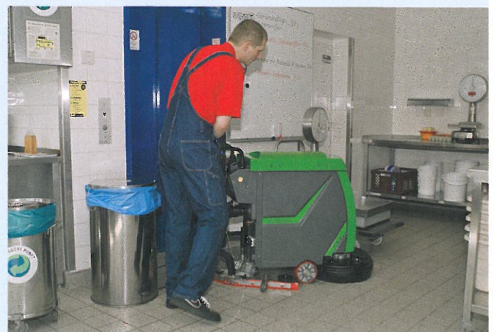
Die 31 B 50 verfügt über einen mitschwingenden Saugfuß aus Edelstahl, der ohne Beschädigung ausklinkt.
